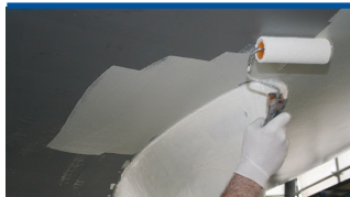
Apply antifouling over primer
